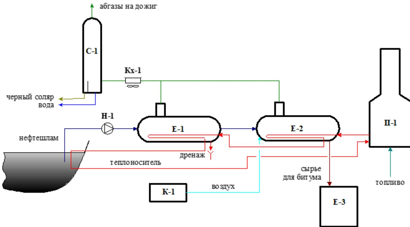
П-1 – печь; Е-1- отпарная емкость; Е-2 – окислительная емкость; Е-3 – резервуар готовой продукции; Н-1 –винтовой насос; К-1 – компрессор; Кх-1 – конденсатор- холодильник; С-1 - сепаратор
